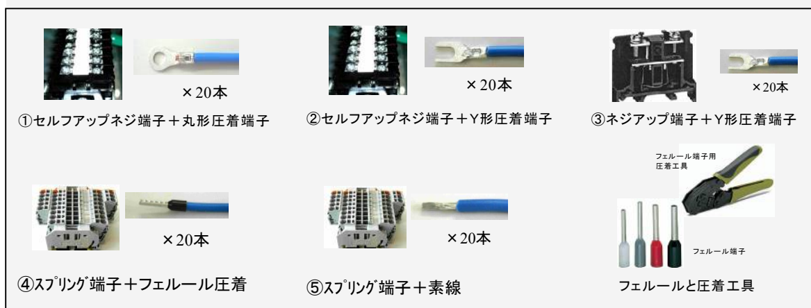
図 8. 制御配線工数測定実験した端子台など
