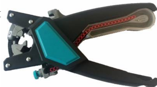
写真 38. 被覆剥&フェルール手動圧着工具 (CRIMPFOX JET)
